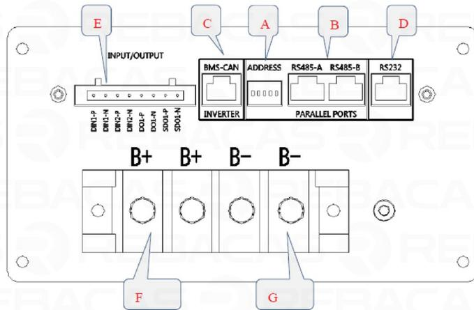
Conectar el puerto C de la batería master WECO 5K3 con el puerto de comunicación de baterías del inversor Axpert MAX 7.2 mediante el cable RJ45
