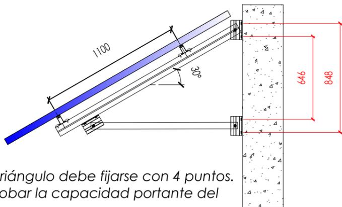
Cada triángulo debe fijarse con 4 puntos.
