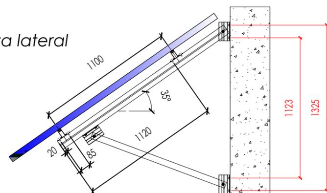
Anclaje al muro mediante tornillo de hasta M10
