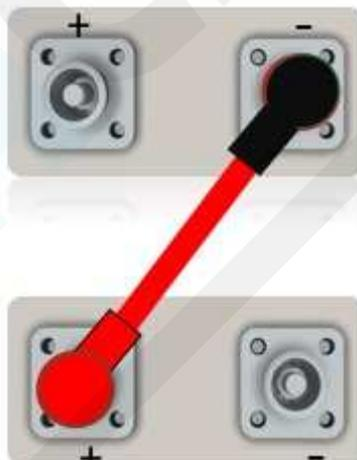
Los terminales de conector rápido solo admiten conexiones en serie de hasta 1000 Vdc
