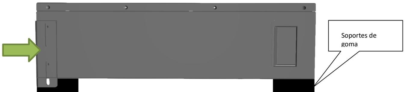
**Paso 4:** Levante y coloque la segunda batería encima de la primera ya instalada en el suelo sobre sus patas de goma.
