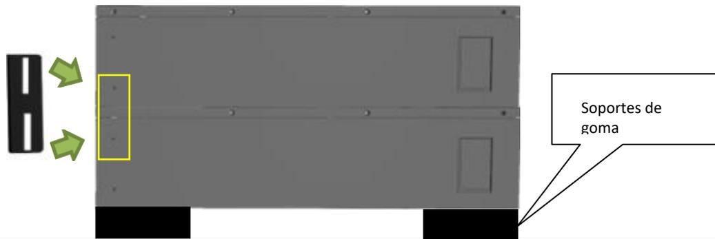
Paso 4: Una vez instalada cada batería en posición horizontal, se pueden retirar las patas suministradas con la batería en configuración estándar e instalarlas a través de los módulos para constreñirlos por ambos lados.
