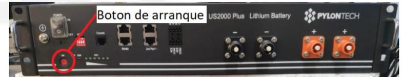
Mantener pulsado el botón de arranque durante un segundo. Una vez se haya iniciado la secuencia de arranque, los LEDs de carga de las baterías se pondrán a parpadear. Por último, el LED de RUN de las baterías se quedará encendido; ello significa que la secuencia de arranque de las baterías habrá finalizado correctamente.
