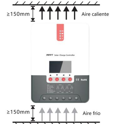
Fig. 2.1 disipación de calor y instalación
