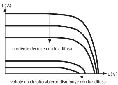
Fig. 1-3 Relación entre la potencia de salida del panel y la luz difusa
