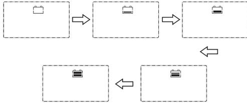
Durante el encendido los 4 indicadores parpadearan, después del autodiagnóstico, la pantalla LCD mostrará el voltaje de batería que será indicado por el usuario y fijado o reconocido automáticamente.
