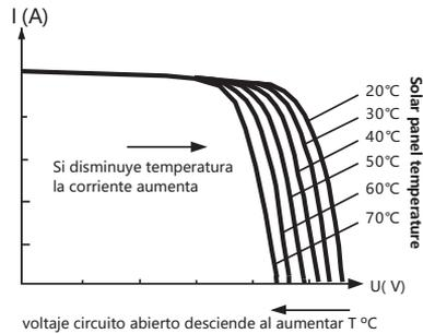
Fig. 1-4 Relación entre la salida de potencia del panel y la temperatura
