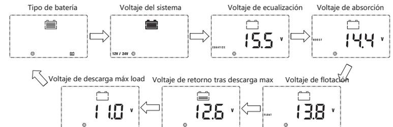
Después de entrar en la configuración del sistema, Aprieta la tecla set para cambiar parámetros, después aprieta la tecl up (arriba) y down (debajo) para subir y bajar el valor sobre el que actuamos. Después apeta la tecla return para salir sin guardar o la tecla set para guardar el cambio
