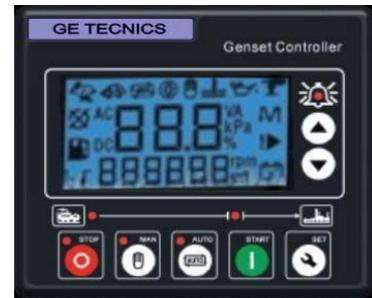
El controlador digital, monitoriza y gestiona el funcionamiento del grupo. Realiza el arranque y parada automáticos por orden programada de tiempos, alarmas, conmutación, etc. Posibilidad de módulos para prestaciones particulares adicionales.
